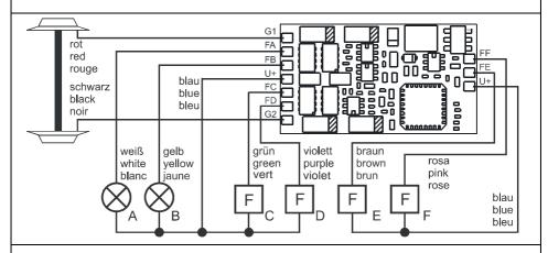
Sur le schéma ci-dessous, on voit que les dispositifs fonctionnels connectés aux sorties C et D ont un pôle commun relié à une sortie voie.
